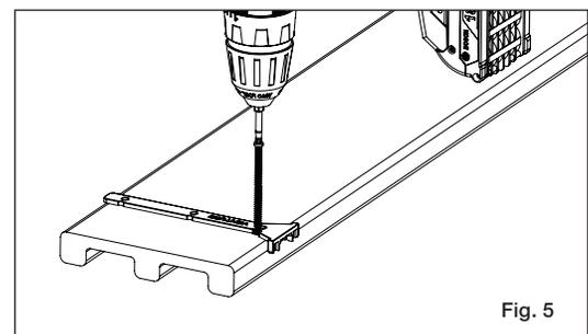
B) Fixation de surface standard : Utilisez deux fixations par platelage à chaque solive. Les vis doivent être placées à 1/2 po des deux extrémités pour s'assurer qu'elles se trouvent dans la zone la plus épaisse.
