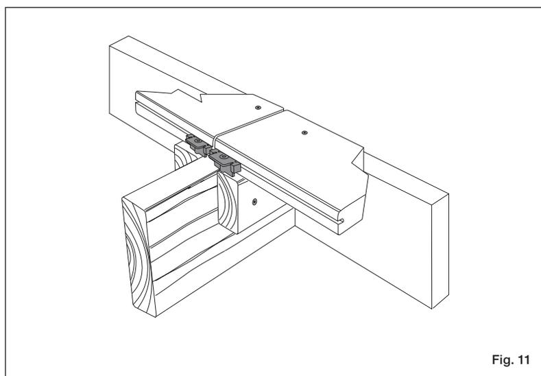
**Étape 3** De l'autre côté du platelage, placez une fixation dissimulée Stowaway dans la rainure et centrez-la sur la solive (fig. 12). Installez la vis pré-réglée à un angle de 90° à travers la fixation Stowaway et vissez-la à ras. Ne pas trop serrer. Les ailes de la fixation doivent rester au niveau de la solive pour que le platelage suivant s'insère correctement (fig. 13).
