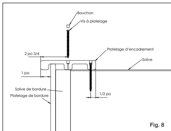
D) Fixation des extrémités de planche : Lorsque deux planches se rencontrent bout à bout sur une solive, ajoutez un blocage supplémentaire (fig. 9 et fig. 10). Les vis doivent être placées à 1/2 po des deux extrémités pour s'assurer qu'elles se trouvent dans la zone la plus épaisse du platelage. Les vis doivent également être placées à au moins 1/2 po de l'extrémité coupée du platelage. Veillez à ne pas trop serrer les vis près des extrémités des planches.
