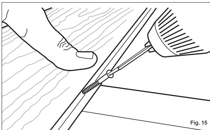
**Étape 6** Installez un clip de fixation dissimulée Stowaway sur la vis et centrez-le sur la solive. Fixez à l'aide d'une vis pré réglée à un angle de 90° à travers la fixation dissimulée Stowaway et enfoncez au ras du clip (fig. 16). Les ailes de la fixation doivent rester au niveau de la solive pour que le platelage suivant s'insère correctement (fig. 17).
