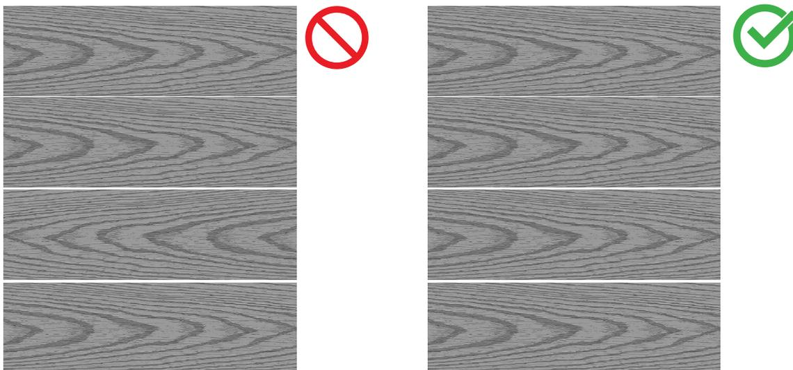
Pour que les espaces soient alignés, vous devez construire en même temps les sections d'une terrasse en deux parties. Cela vous permettra d'ajuster les variations naturelles de la largeur des planches au fur et à mesure. Tracez une ligne au début de la pose du platelage, puis prenez une mesure à toutes les 2 ou 3 rangées à partir de la ligne d'origine.
