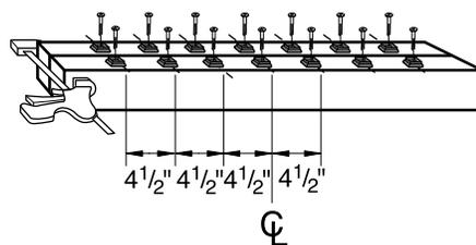
**Étape 4 :** Placez la rampe inférieure (2x4) sur les blocs de 3" (un matériau de déchet de 2x4 marche mieux) et fixez-le au barreau. Pour une connexion de rampe à barreau facile, nous vous recommandons d'utiliser des connecteurs de garde-corps Deckorators (vendu séparément). Mettez un adhésif transparent sur chaque connecteur pour sécuriser convenablement les balustres et pour les empêcher de tourner. Insérez les balustres sur les connecteurs de balustre.
