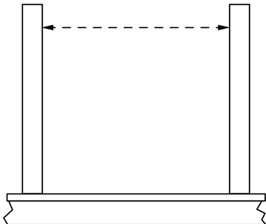
**Étape 2 :** Coupez les rampes supérieures et inférieures (2x4) pour mettre en longueur et attacher ensemble. À partir du centre des rampes, marquez 4-1/2" centre à centre en utilisant un ruban métrique ou un carré rapide marqué. Ceci laissera une ouverture de 3-3/4" de balustre à balustre une fois que les balustres sont installés.
