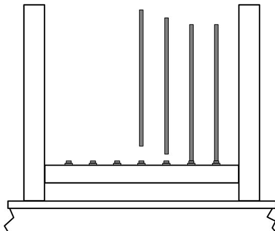
**Étape 5 :** Mettez la rampe supérieure (2x4) sur les balustres. Installez les rampes chaperons pour un aspect fini. Pour les sections de rampes plus longues que 4 pieds, des blocs de support sont recommandés. Ceux-ci peuvent être fabriqués à partir de restes de matériau de rampe. Positionnez correctement le bloc de support et clouez en biais à la rampe inférieure et à la planche de pont.
