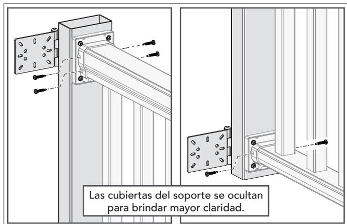
Fije el panel del riel a cada soporte del riel con seis de los tornillos auto perforantes n.º 10 proporcionados.
